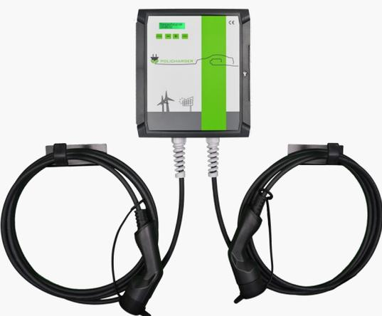
Equipos dobles. 2 mangueras para la carga simultánea de 2 vehículos. Permiten la carga de un vehículo hasta 32A, y la carga 2 vehículos simultáneamente hasta 16A cada uno
