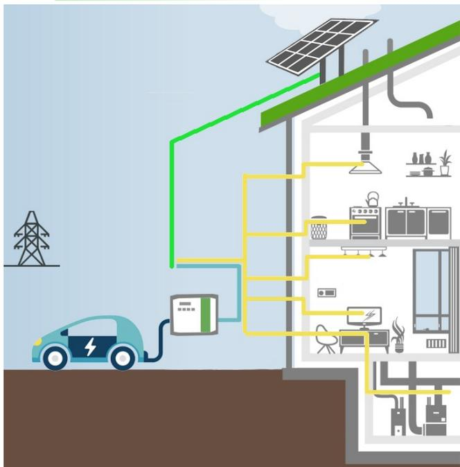
Wallbox Policharger con control solar, permite la configuración para funcionar tanto con vertido a red, como con inversores de vertido 0.
