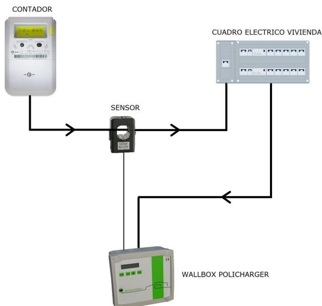
Cada wallbox Policharger incluye un sensor no invasivo, que medirá el consumo de la vivienda y transmitirá ese dato constantemente al wallbox a través de un cable apantallado de 2 hilos.
